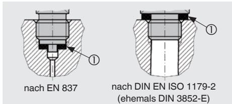
Zur Abdichtung der Prozessanschlüsse mit zylindrischem Gewinde sind an der Dichtfläche ① Flachdichtungen, Dichtlinsen oder WIKA-Profilabdichtungen einzusetzen.
