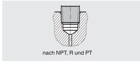
Zur Abdichtung der Prozessanschlüsse mit kegeligem Gewinde erfolgt die Abdichtung im Gewinde, mit zusätzlichen Dichtwerkstoffen z. B. PTFE-Band (EN 837-2).
