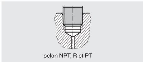
Pour des raccords process avec filetages coniques, l'étanchéité sur le filetage doit se faire en utilisant en plus un matériau d'étanchéité comme par exemple la bande PTFE (selon EN 837-2).
