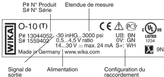
Si le numéro de série devient illisible à cause de dommages mécaniques ou de peinture, aucune traçabilité n'est plus possible.
