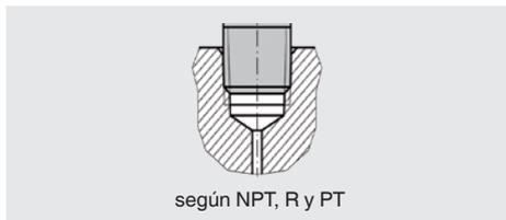
Para sellar las conexiones a proceso de forma cónica, el sellado se realiza en la rosca con material suplementario, como por ejemplo, cinta PTFE (EN 837-2).
