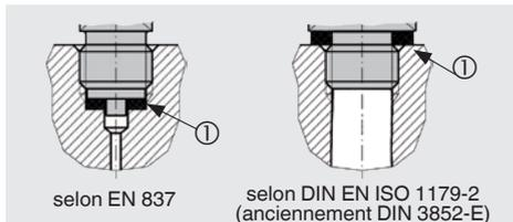
Pour assurer l'étanchéité des raccords process avec filetages parallèles à la surface d'étanchéité (1), il faut utiliser des joints plats, des bagues d'étanchéité ou les joints à écrasement WIKA.
