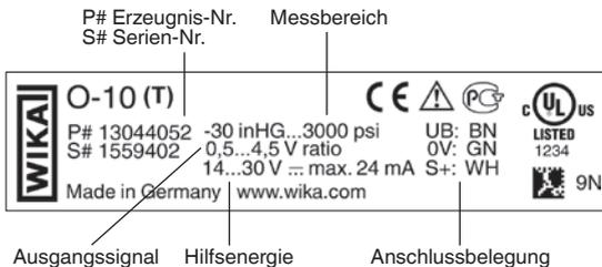
Wird die Seriennummer durch mechanische Beschädigung oder Übermalen unleserlich, ist eine Rückverfolgbarkeit nicht mehr möglich.
