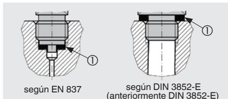
Para el sellado de las conexiones al proceso con roscas cilíndricas en la superficie de obturación ① se deben instalar juntas planas, arandelas o juntas perfiladas WIKA.
