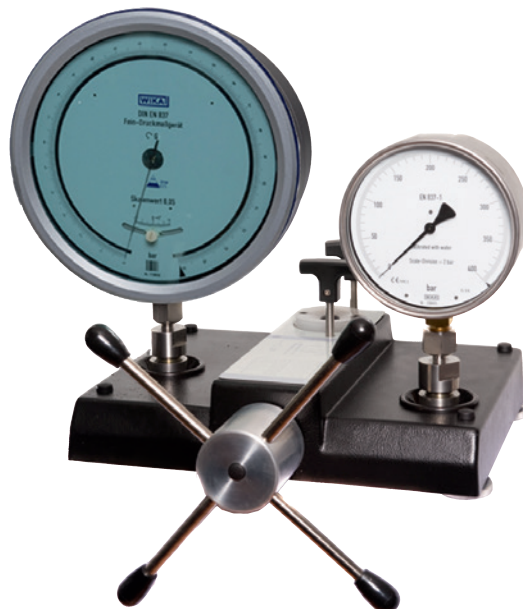
Configuración de calibración CPP1200-X con manómetro de precisión como instrumento de referencia e instrumento a comprobar
