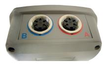
2 puertos de conexión para entradas de sensores de temperatura
