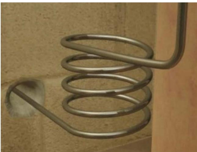
Espiral de dilatación proveniente del horno
