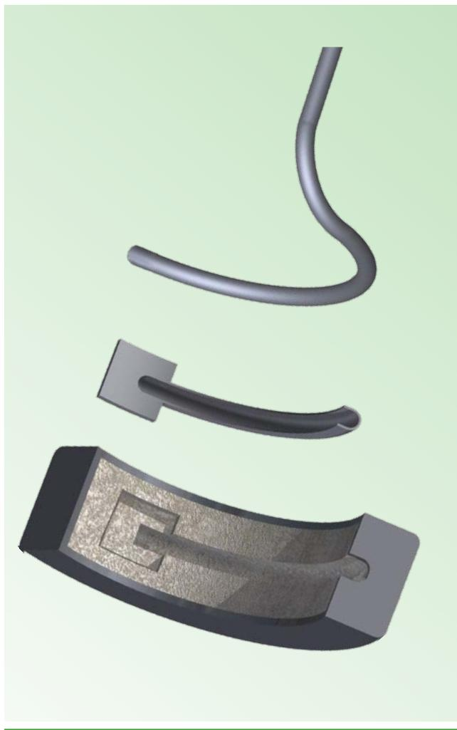
“Este diseño (Xtracto-Pad™) es un estándar probado en todos los tubos de horno con alto contenido de cromo, que requieren extensos tratamientos térmicos antes y después de la soldadura ...”
