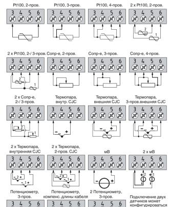
для 2 измерений, разности, среднего значения или в качестве системы с резервированием.
