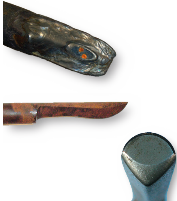
Повреждения защитных гильз, подвергшихся абразивному воздействию (примеры)
